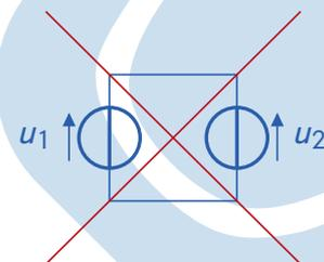
Il ne faut jamais **court-circuiter une source de tension**. Cela entraînerai la circulation d'un courant infini.
